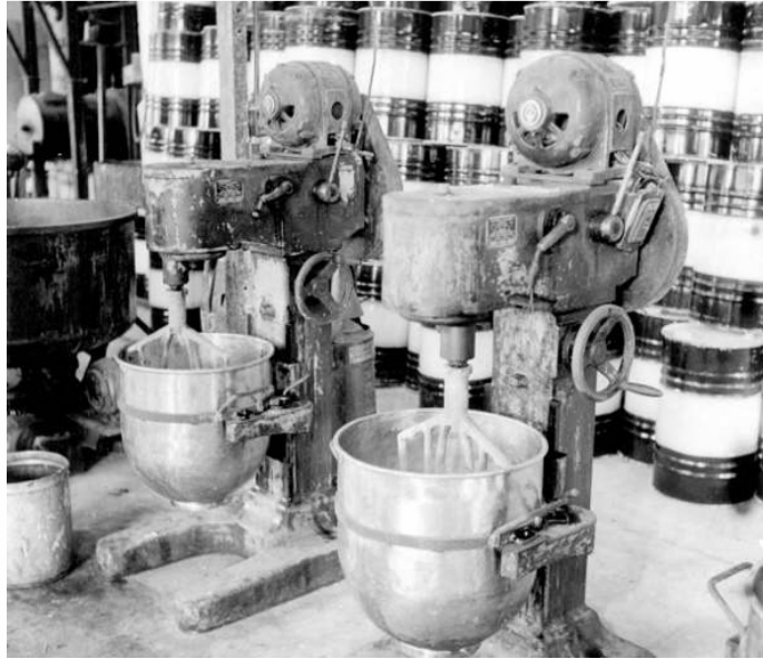
Imagem 39 - Equipamentos utilizados para a fabricação da pasta de DDT, no Serviço Nacional de Malária. Rio de Janeiro (RJ), 1956. Arquivo Paulo Barragat, Casa de Oswaldo Cruz/Fiocruz.
